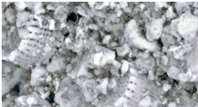
Koralna struktura funkcionalnog filera u Baunit StarTop fasadi
